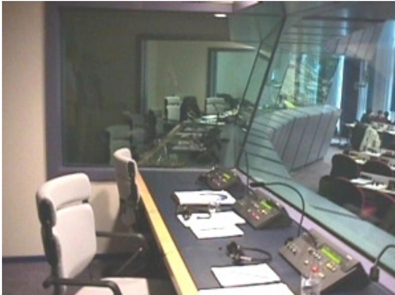
Über die gesamte Kabinenbreite ist eine Tischplatte zu montieren, und zwar mit genügend Platz für die Dolmetschtechnik sowie für Unterlagen, Nachschlagewerke, Laptops und andere Materialien, die die Dolmetscher benötigen.
